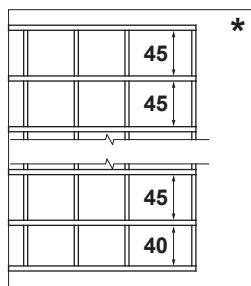
\* Рекомендуется устанавливать стенки узкой ячейкой (40 мм) вниз.
