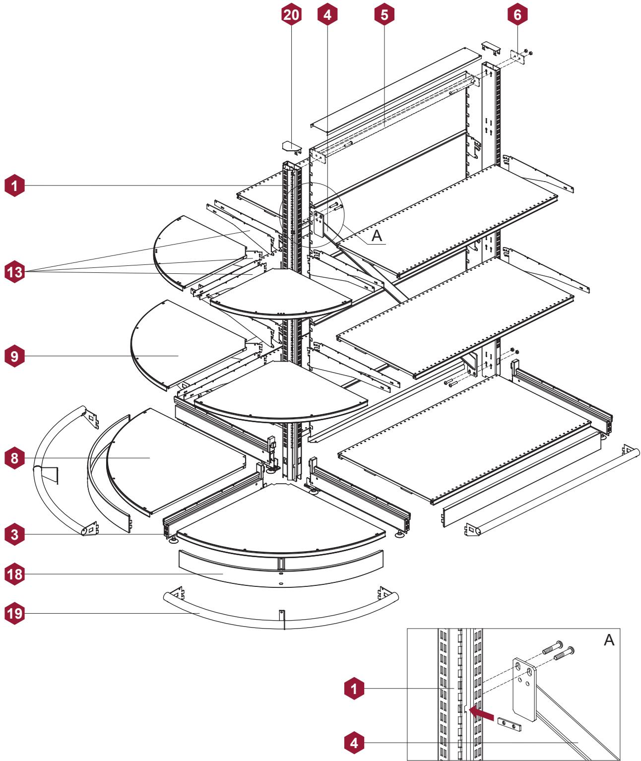
СТЕЛЛАЖ С СЕТЧАТОЙ ПОЛУКРУГЛОЙ ТОРЦЕВОЙ СЕКЦИЕЙ -
