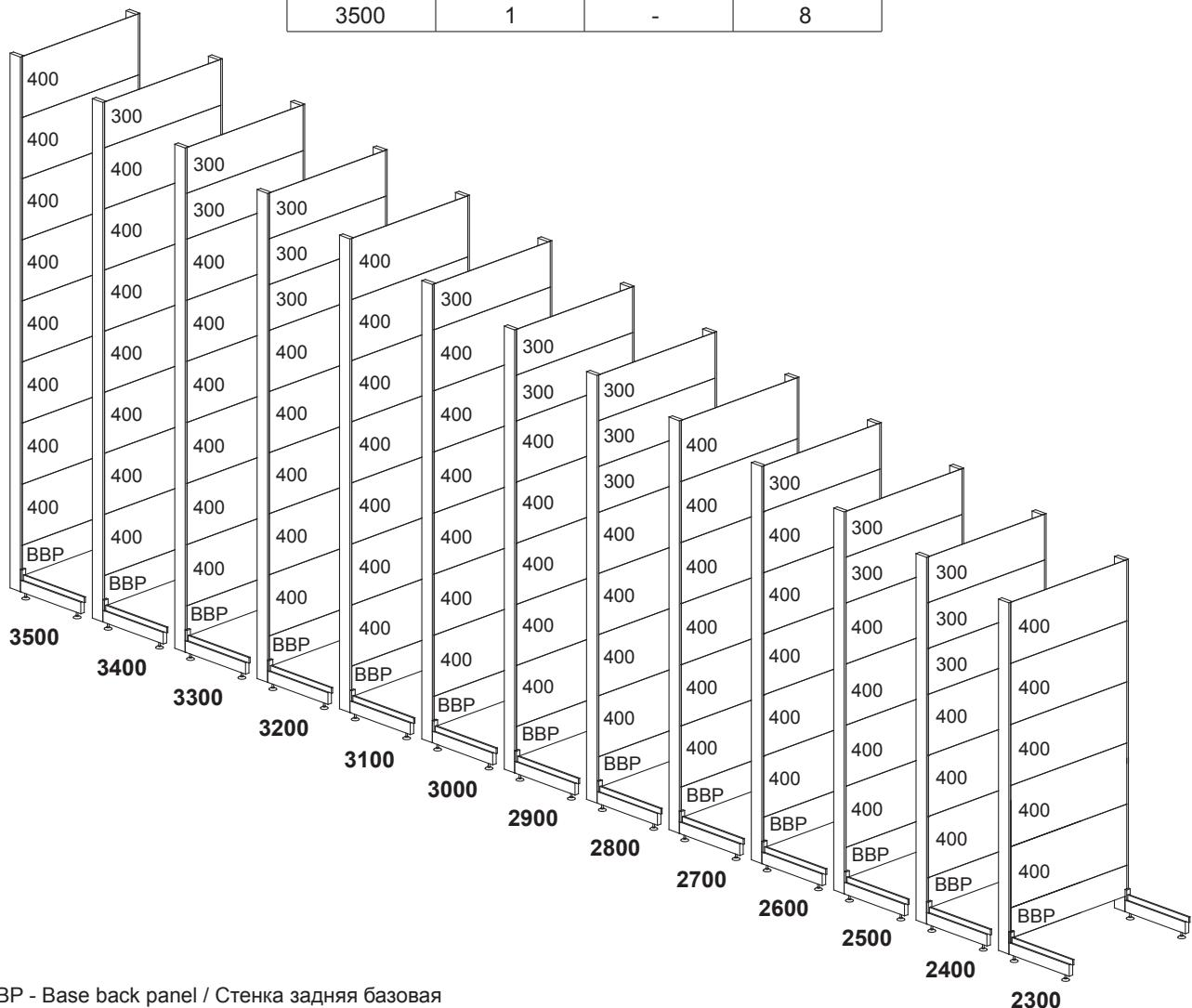
\*BVP - Base back panel / Стенка задняя базовая
